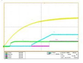
Figure 42:PV $_{\rm in}$  Start up at 35A Load  ${\rm Ch}_1{:}{\rm P}_{{\rm Vin}}, {\rm Ch}_2{:}{\rm V}_{\rm out}, {\rm Ch}_3{:}{\rm P}_{{\rm Good}}, {\rm Ch}_4{:}{\rm V}_{\rm cc}$
