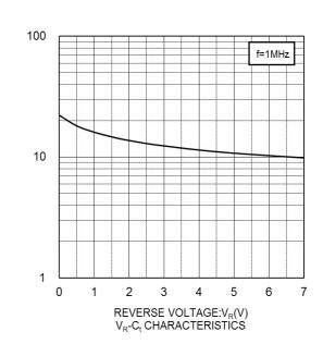
CAPACITANCE BETWEEN TERMINALS:C<sub>t</sub>(pF)
