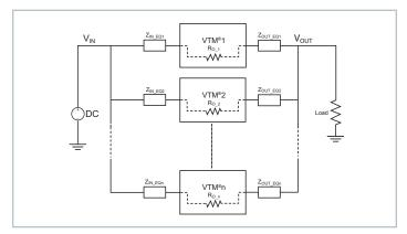
**Figure 4** — VTM module array
